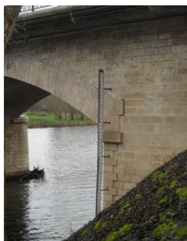
Figure 83 : Echelle de la station Vigicrues de Lussac-les-Château (Pont de Mazerolles) sur la Vienne
