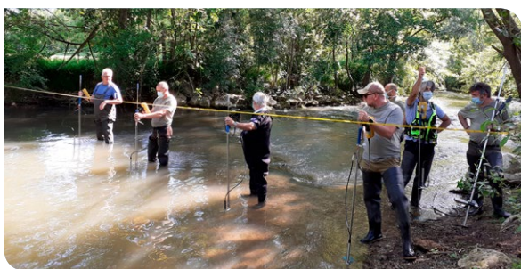
Action de jaugeage à la perche menée pour mesurer le débit d'un cours d'eau. (image : DREALNA)
