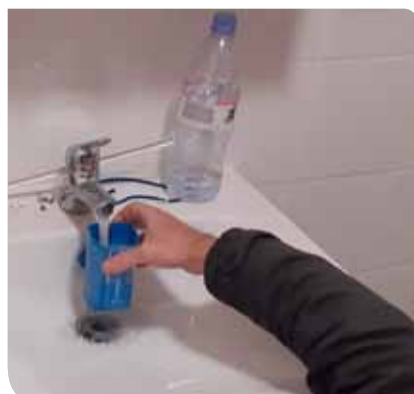
Mesure de débit lors d'un diagnostic
